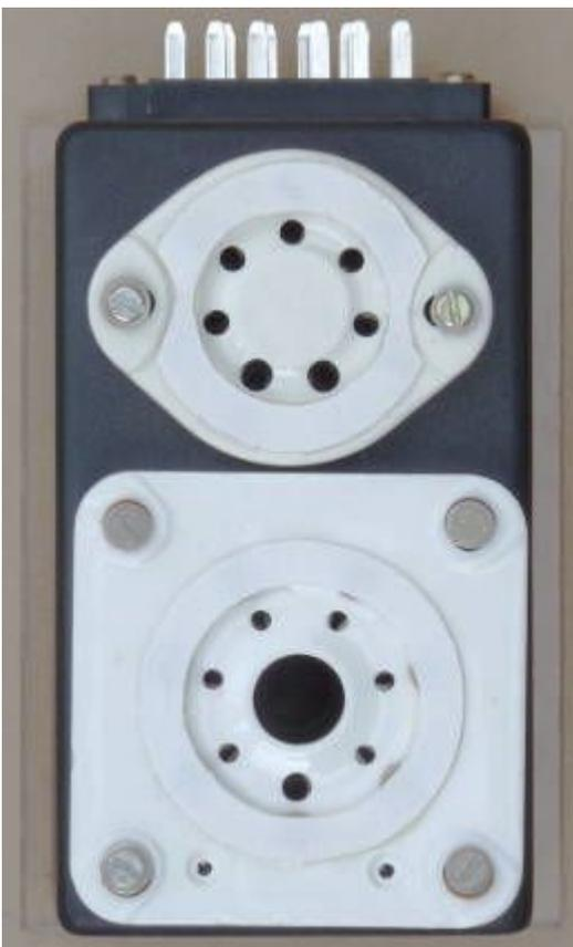
Die **Box links** hat oben eine Fassung **U7B** und unten eine Fassung **Septar** oder **B7A**.
