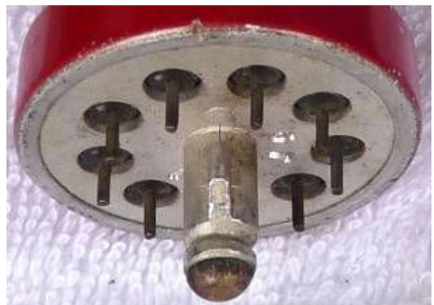
Wenn Sie also eine 9-polige Loctal-Fassung einbauen wollen, so erwerben Sie besser eine Fassung für einen Einbau über der Montageplatte. Dabei sollen die Kontakte der Fassung möglichst geringen Abstand zum Röhrenboden haben.
