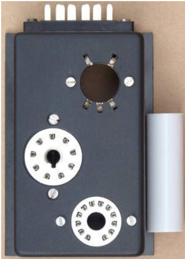
Meine **Box für diverse britische und USA Röhren** umfasst je eine Fassung für **5-polige Acorn** (Eichel-Röhren), für **9-polige Loktal**-Röhren und die **Compactron**-Röhren.
