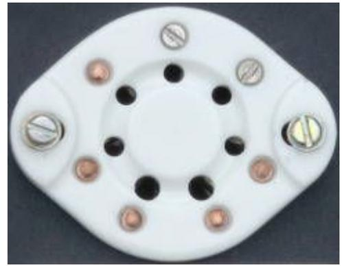
Unten in der Box ist eine **Septar-Fassung** aus China eingebaut. Bei Röhren mit Septar-Sockel sind die Sockelstifte nur 11mm lang, davon können die unteren 3mm angespitzt sein. Damit die Sockelstifte die Fassungskontakte noch sicher erreichen können, muss die Röhre wirklich direkt auf der Keramikplatte der Fassung aufsitzen. Das ist auch der Grund, warum ich bei dieser Box die Fassungen oben auf der Box montiert habe.
