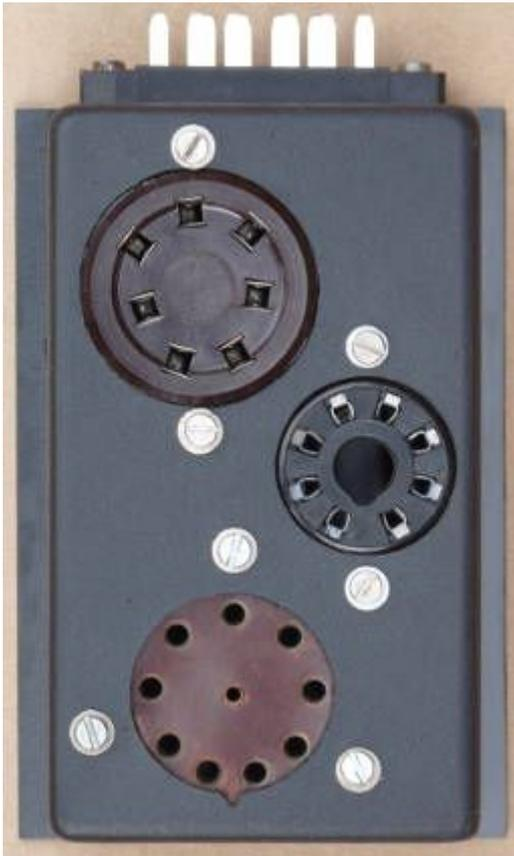
Meine **Box für ältere britische Röhren** enthält oben die Fassung **British 7 Pin** oder B7 oder M7A.
