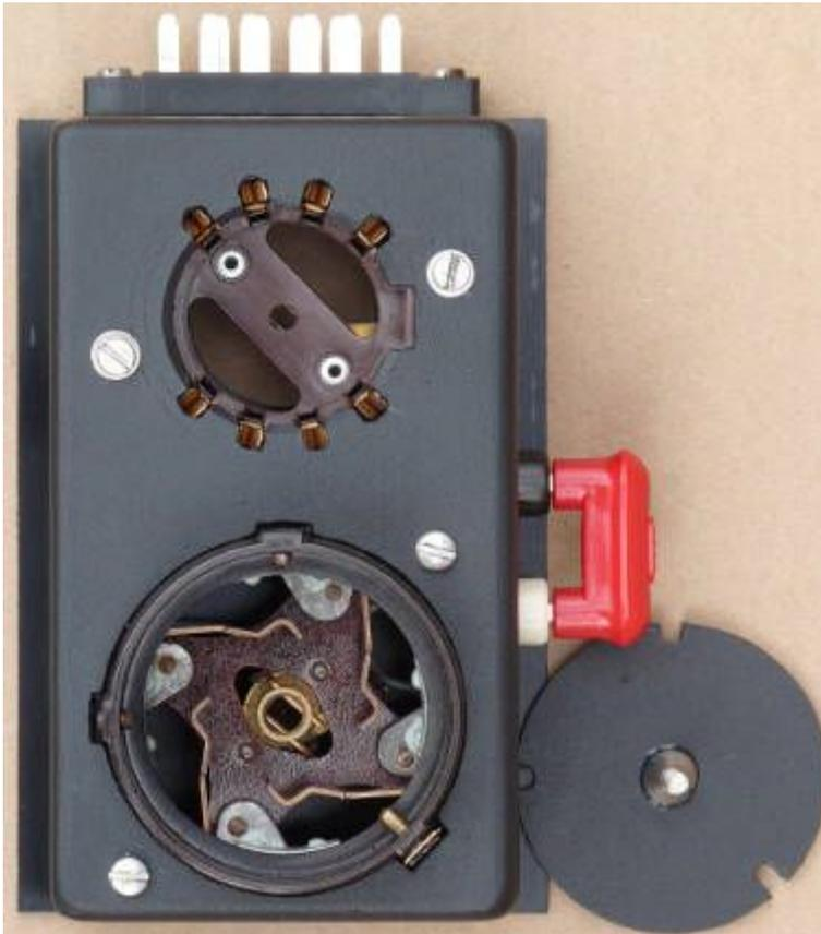
Die nächste Box hat oben eine Fassung "Wehrmacht LG1688", beispielsweise für Röhren **RL12P10** oder **RL12P50**. Die untere Fassung "Wehrmacht LG1678" ist etwa für die **RL12P35**.
